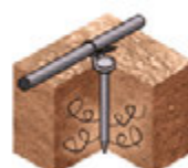
Sol remblai ou bitume
